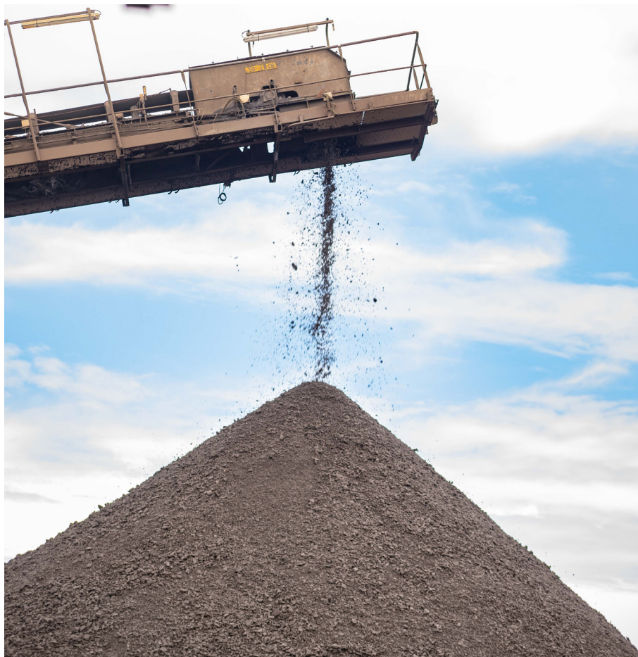
Chute de minerai en sortie de crible.
